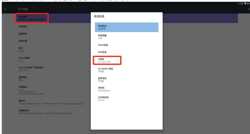
3. 电脑cmd 进入到adb 命令行，键入 adb connect 板卡ip 地址:端口号，端口号为5566。
