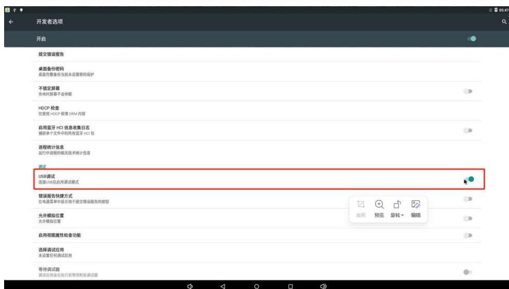
4. 在板卡系统【设置】菜单中选择“USB”选项，打开“连接到 PC”开关。
