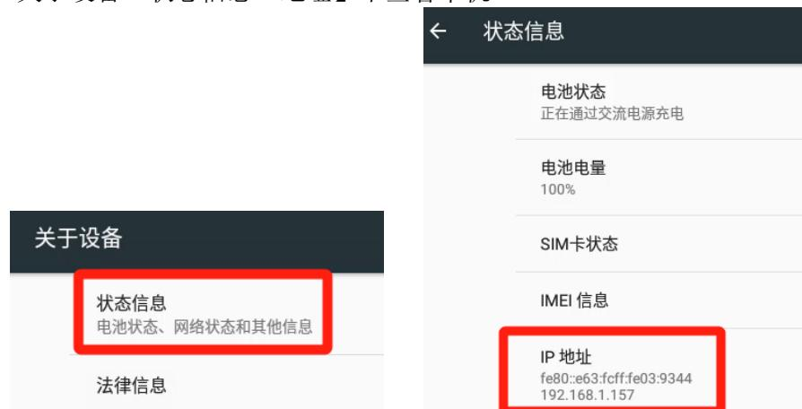
3. 电脑cmd 进入到adb 命令行，键入 adb connect 板卡ip 地址:端口号，端口号为5566（注：DS960X端口号是5555）
